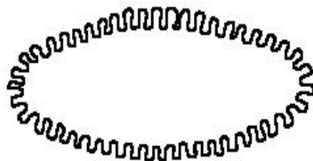
Günstige Form eines Atemkalkkörnchens (große Oberfläche)
